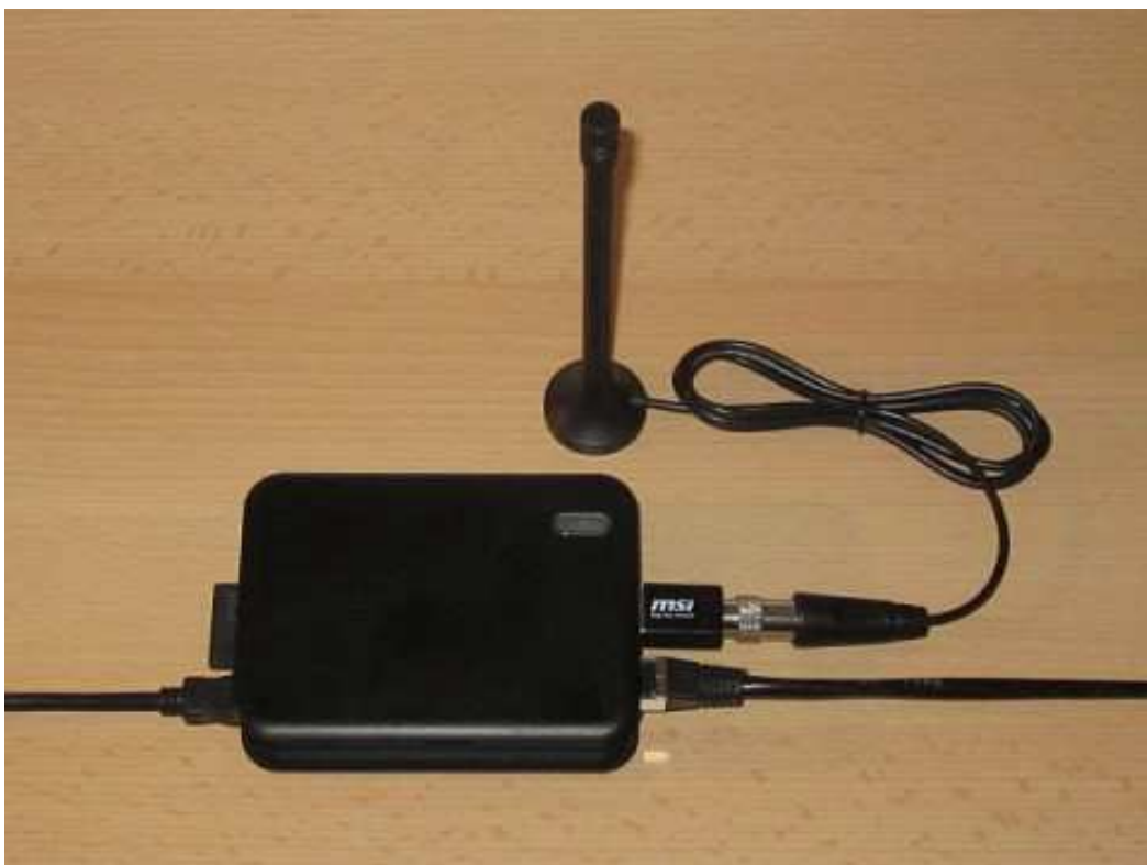
HAMServerPi: Raspberry Pi im Gehäuse mit DVB-T-Stick für APRS-Empfang
